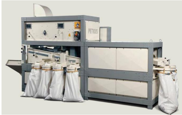
Saatgutaufbereiter Petkus K541 (Siebe, Windsichtung, Zellenausleser, 1,25-1,75 t/h) Voraussichtlich wird eine Maschine dieser Art vor Ort ausgestellt.
